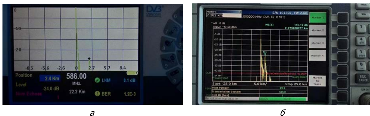
Рис. 8. Измерение эхо-сигналов: EFL (а); ETL (б)
