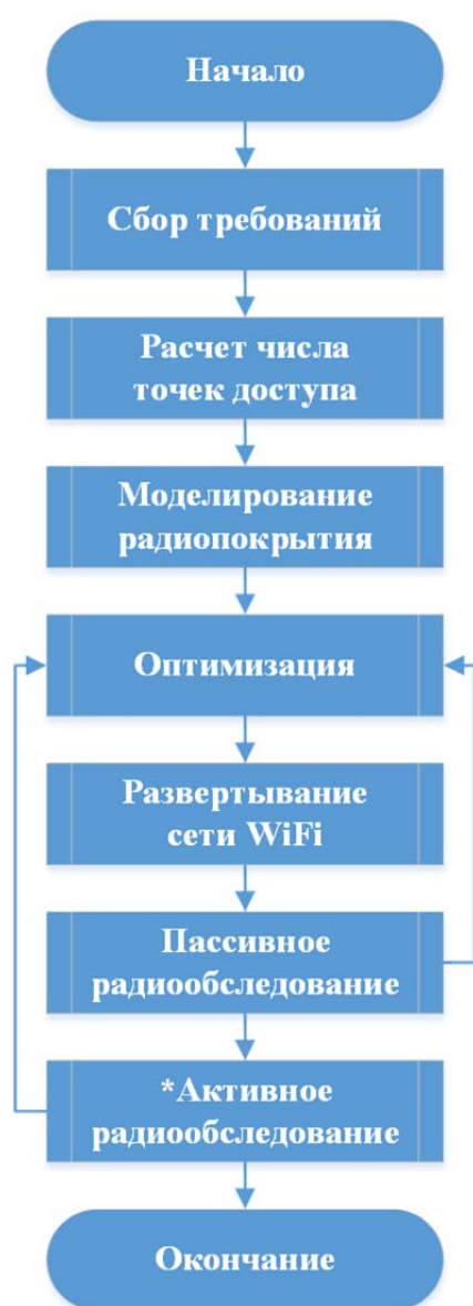
Рис. 2. Алгоритм проектирования и оптимизации сетей Wi-Fi
