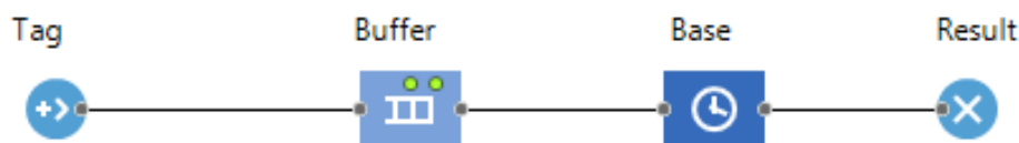
Рис. 2. Имитационная модель одноканальной СМО с ожиданием, построенная в среде AnyLogic
