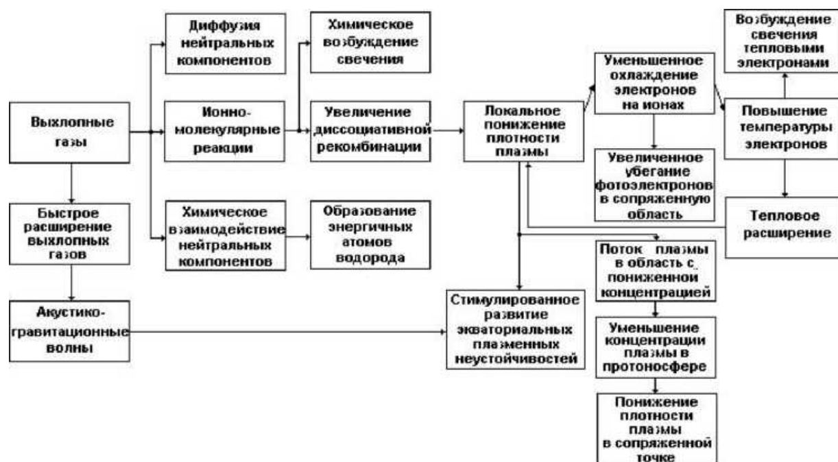
Рис. 1. Схема физических процессов и последствий запусков ракетно-космической техники на верхнюю атмосферу
