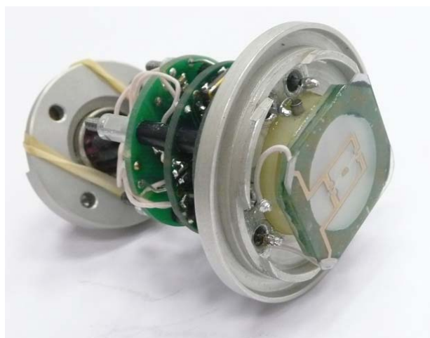
Рис. 3. Датчик давления ДДАЭ-И в разобранном виде
