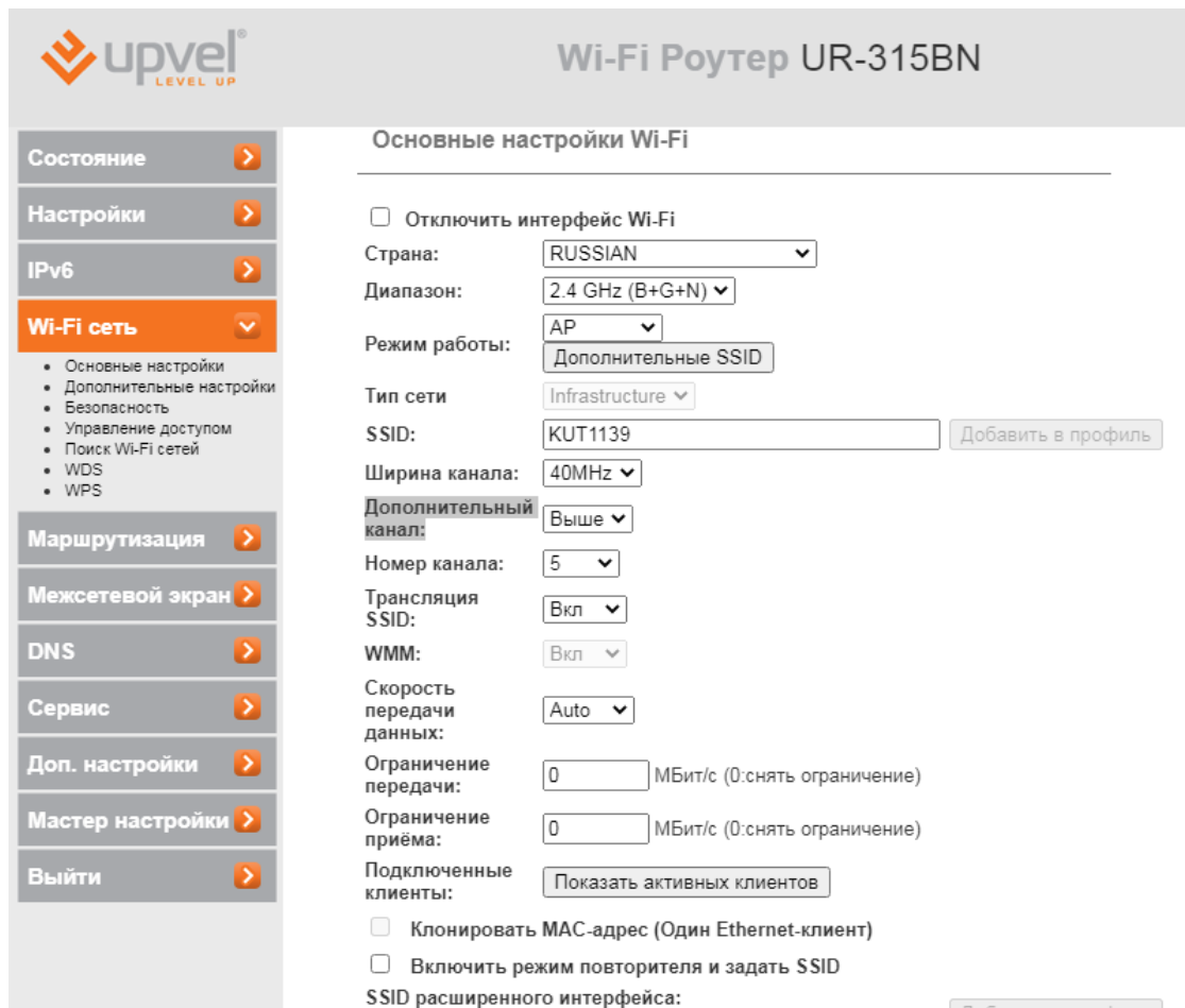
Рис. 2. Интерфейс Wi-Fi роутера Upvel UR-315BN с возможностью выбора варианта дополнительного канала, объединяемого с основным
