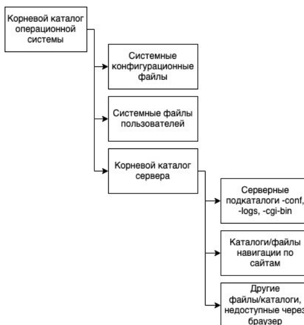
Рис. 1. Концептуальное устройство веб-сервера
