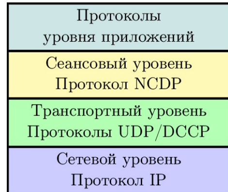
Рис. 3. Размещение предлагаемого протокола NCDP в рамках структуры сетевых моделей OSI и TCP/IP
