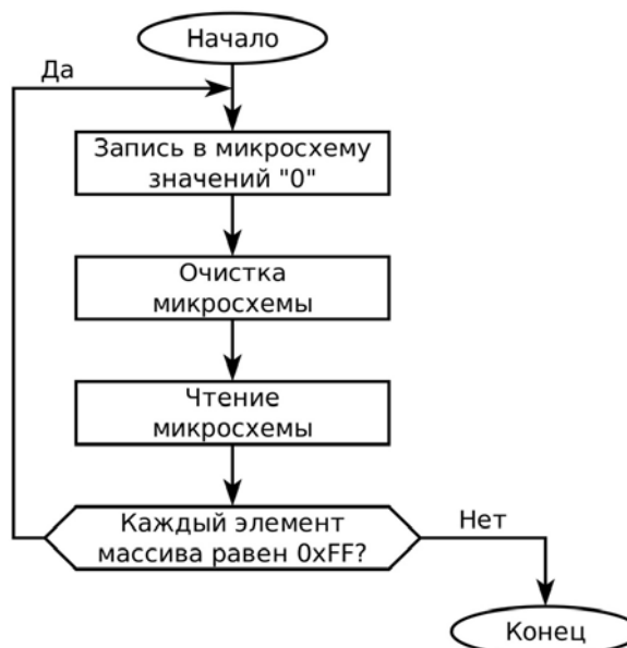
Рис. 1. Алгоритм получения микросхем памяти с деградированными ячейками
