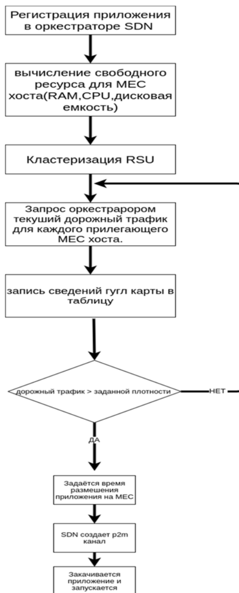
Рис. 2. Предлагаемый алгоритм организации передачи
